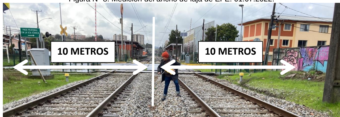
Figura N° 8. Medición del ancho de faja de EFE. 01.07.2022.
